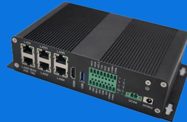
TE820 5G智能边缘终端支持5G+边缘 AI，是基于移动互联网络需求而研发的集成5G网络、Wi-Fi 网络、千兆TSN网口、USB3.0、RS485、CANFD、RS232等多种工业现场总线及接口于一体的工业智能边缘终端产品。系统支持2.3 TOPS神经网络NPU边缘算力，可以分担部署在云端的计算资源，承载边缘侧AI算法的推理与应用。采用硬件加密技术，提供丰富的接口扩展能力，可以高速处理协议和大量数据，在物联网边缘节点实现数据优化、实时响应、敏捷连接、模型分析等业务。
