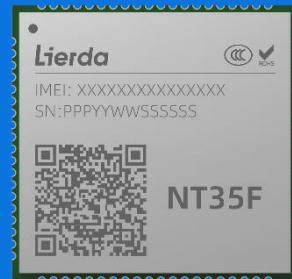
NT35F系列产品是基于移芯EC718芯片平台打造的LTE Cat.1 bis系列工业化模组，模组采用方便贴片的LCC+LGA封装，支持LTE 3GPP Rel.13标准，支持FDD-LTE/TDD-LTE的远距离通讯模式。模组有东南亚版本和欧洲版本。模组具有体积小，入网速度快，极致功耗等特点。NT35F系列模块支持最大下行速率10Mbps和最大上行速率5Mbps，具有超高的性价比；模组内置丰富的网络协议，集成多个工业标准接口，并支持多种驱动和软件功能（如Windows7/8/8.1/10, Linux, Android等操作系统的USB驱动等），极大地拓展了其在M2M领域的应用范围，可用于LTE Cat.1 bis基础应用，包含对速率要求不高的行业应用，如定位器、工业设备、电表、DTU、集中器、IPC等场景。
